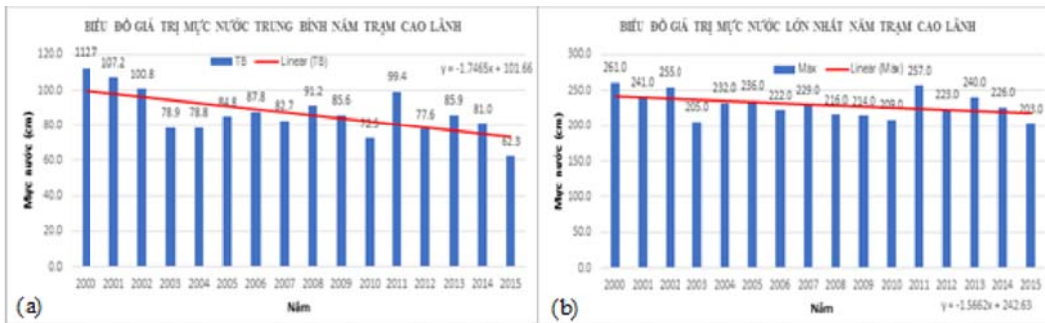
Hình 7. (a) Biểu đồ diễn biến H_b năm tại Cao Lãnh; (b) Biểu đồ diễn biến H_{max} năm tại Cao Lãnh
