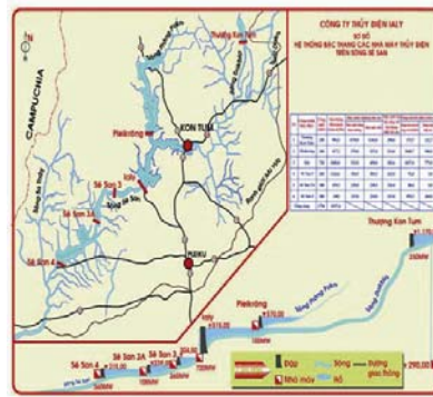
Hình 2. Hệ thống bậc thang các nhà máy thủy điện trên sông Sê San
