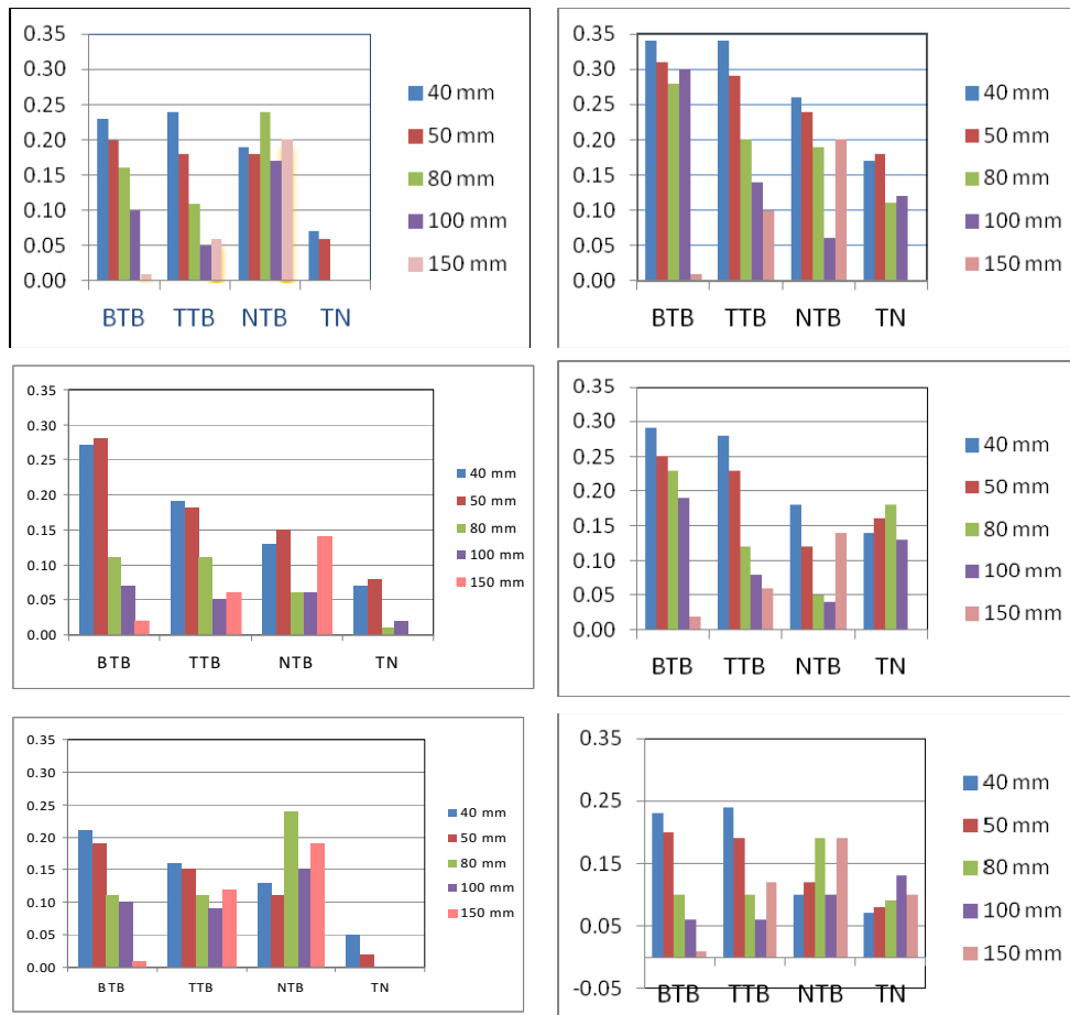
Hình 1. Chỉ số TS cho 4 khu vực BTB, TTB, NTB và TN với 5 ngưỡng mưa 40, 50, 80, 100 và 150 mm/24h từ mô hình GSM (cột bên trái) và IFS (cột bên phải) cho hạn dự báo 00 - 24h (trên), 24 - 48h (giữa) và 48 - 72h (dưới)
