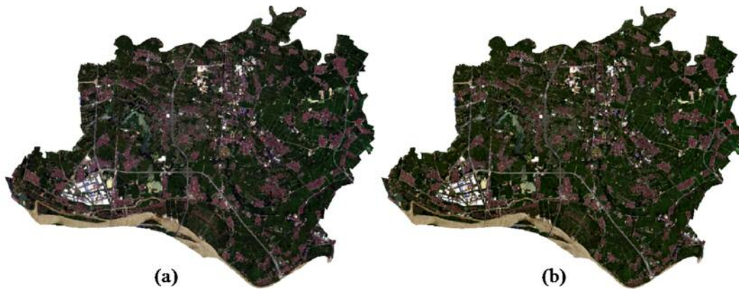
Hình 2. Ảnh vệ tinh LANDSAT trước (a) và sau (b) hiệu chỉnh ảnh hưởng của khí quyển
