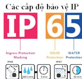
Hình 7. Minh họa cấp độ bảo vệ thiết bị theo tiêu chuẩn IP.
