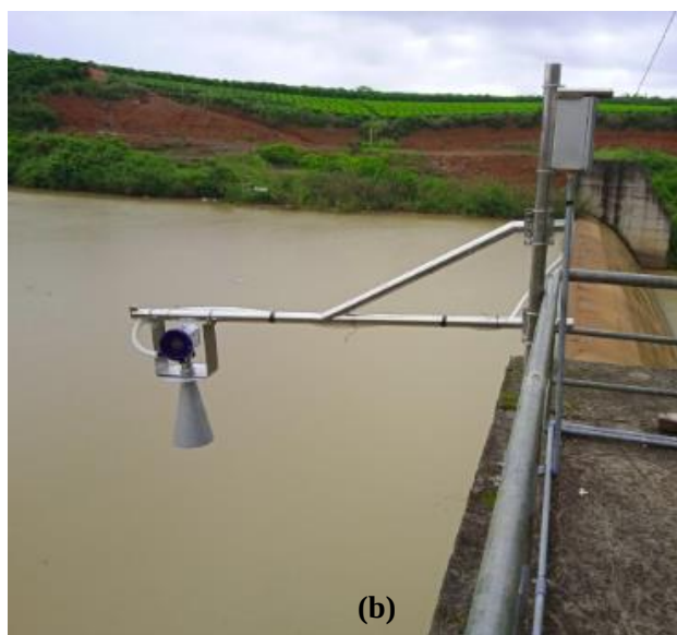
Hình 1. Minh họa thiết bị đo mực nước bằng công nghệ radar và hình ảnh thiết bị thực tế.
