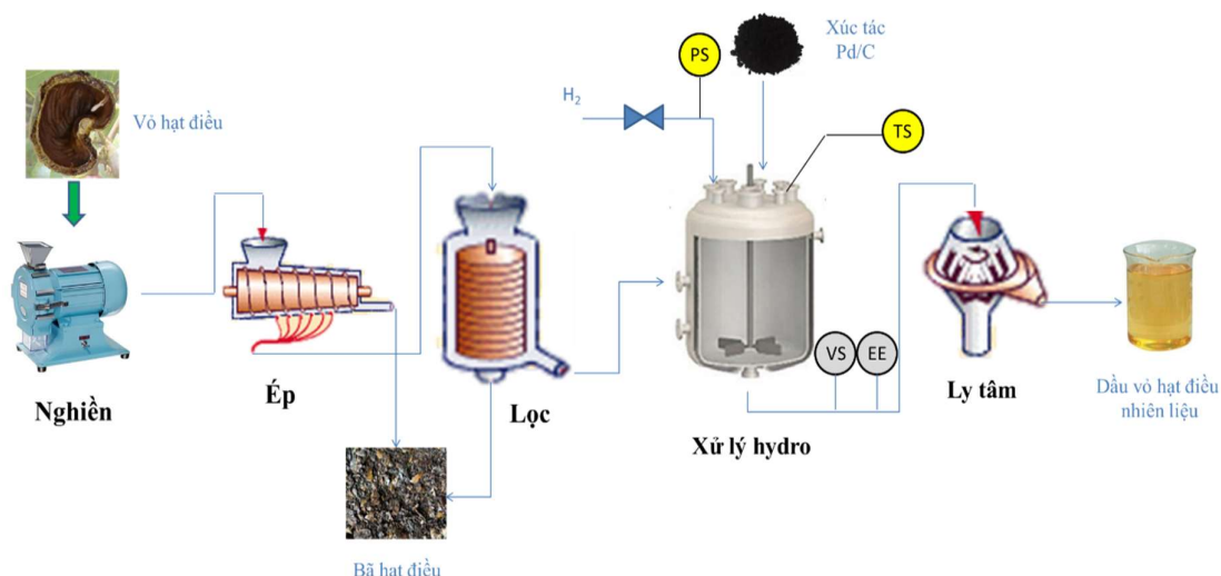
Hình 3. Sơ đồ quy trình công nghệ sản xuất dầu vỏ hạt điều tinh chế ứng dụng làm dầu nhiên liệu có tích hợp công nghệ IoT.
