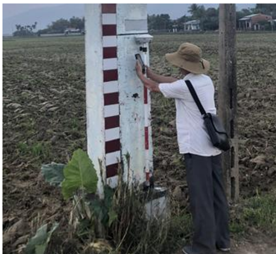
Hình 2. Điều tra, khảo sát, đo đạc vết lũ ứng dụng công nghệ RTK.
