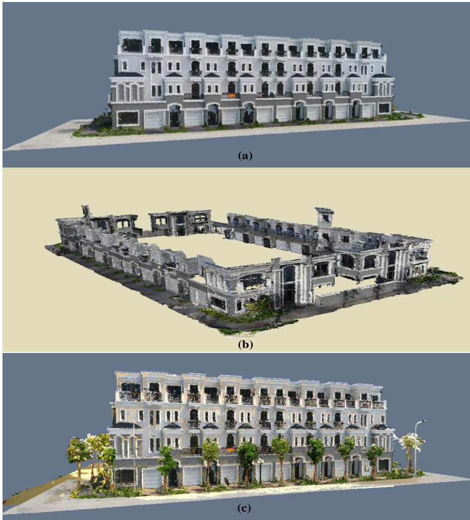
Hình 3. Kết quả đám mây điểm của một dãy biệt thự liền kề từ: (a) Ảnh chụp UAV; (b) Chụp ảnh mặt đất; (c) Ghép từ hai công nghệ UAV và chụp ảnh mặt đất.
