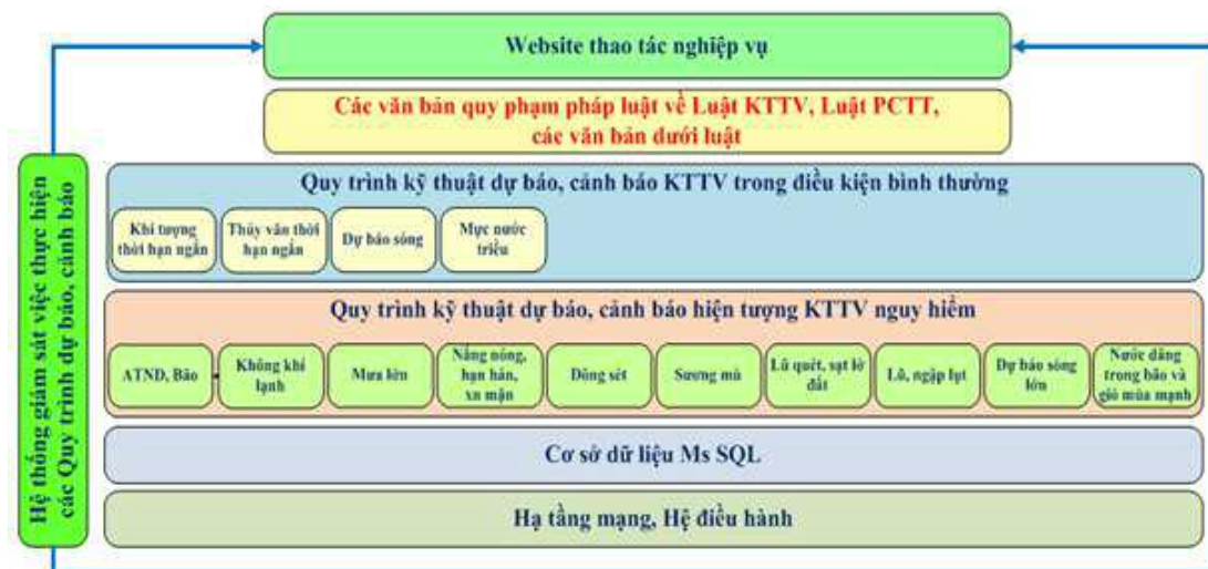
Hình 2. Kiến trúc Hệ thống giám sát trực tuyến việc thực hiện quy trình dự báo, cảnh báo khi tượng thủy văn
