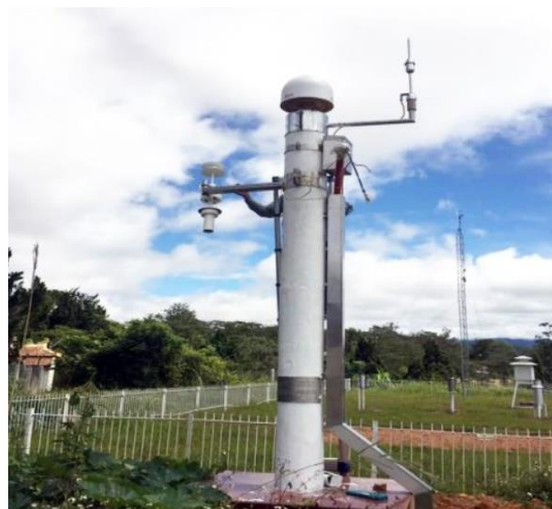
Hình 2. Một trạm CORS thuộc mạng lưới VNGEONET.
