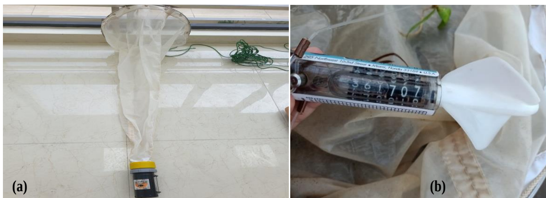
Hình 2. Lưới lấy mẫu vi nhựa: (a) Lưới thu mẫu, (b) Flometer.
