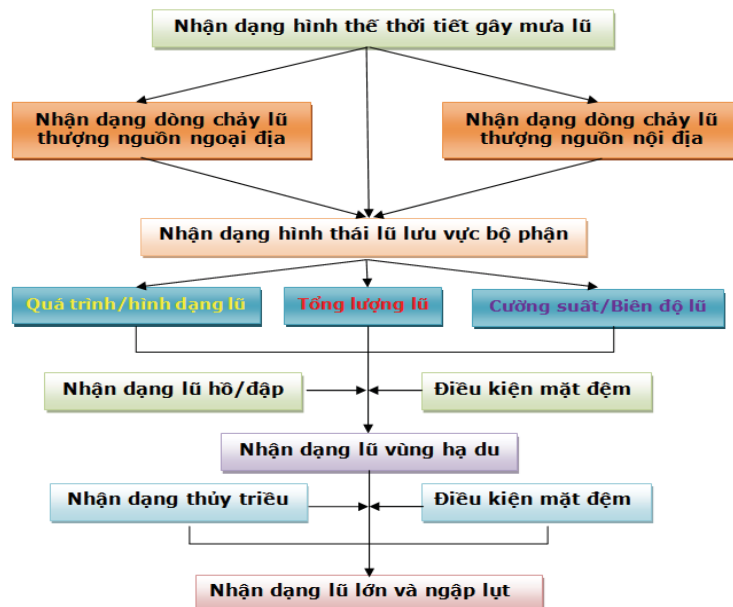
Hình 1. Sơ đồ nhận dạng toàn diện lũ trên lưu vực sông Lam
